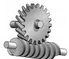
$n_2 = 90$  dientes,  $e = n_1 = 3$  entradas,  $v_1 = 60$  rpm,  $v_2 = ?$
