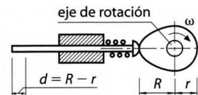
11. ¿Qué radio mayor debe tener una excéntrica, si el eje de rotación tiene un radio de 2 cm. y el desplazamiento que realiza en el movimiento de salida es de 60 mm.?
