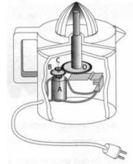
$$v_1 = 1800 \text{ rpm} \quad n_1 = 10 \text{ dientes} \quad n_2 = 50 \text{ dientes} \quad v_2 = ?$$
