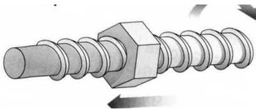
Colocada en horizontal, si giramos la varilla en el sentido de las agujas del reloj, la tuerca se desplaza hacia la **izda**, si la giramos al contrario de las agujas del reloj girará hacia la **dcha**.
