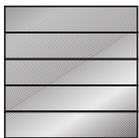
**Medir y marcar:** dividir la plancha en cinco tiras iguales de 20 × 4 cm. Se marcan con la bigotera líneas paralelas al borde de 4 cm de grosor.
